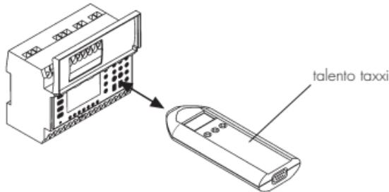
Attenzione: Se i dati non vengono trasferiti correttamente nel Display appare l'indicazione di errore **Er 02**.
