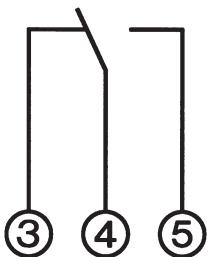
Entre le borne 4 et borne 5 le contact se ferme = chauffage en marche
