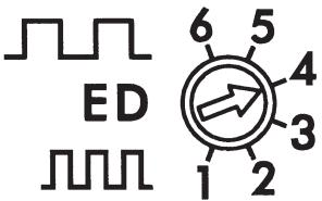
Le réglage du cycle de fonctionnement du chauffage (valeur Ed) sert à adapter le système de régulation.
