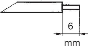
Dénuder la portion du câble nécessaire et raccorder aux bornes suivant le schéma approprié.
