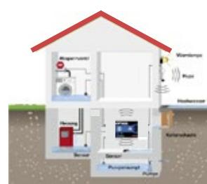
Fernüberwachung von Füllständen mit Alarmübermittlung
