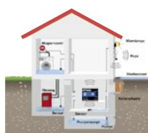
Surveillance des niveaux de remplissage avec envoi d'alarme
